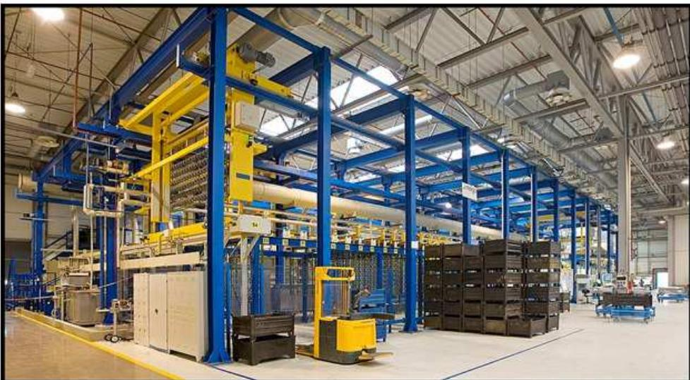
V procese výroby brzdových strmeňov zabezpečuje povrchovú úpravu predtým obrobených odliatkov, poprípade čistenie hliníkových odliatkov po procese obrábania. Povrchová úprava odliatku má za úlohu zvyšovať koróznu odolnosť minimálne na úroveň požadovanú zákazníkom.
