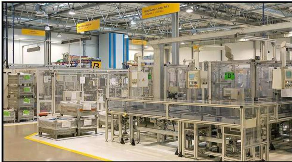
13 montážnych liniek určených pre proces výroby hotových brzdových strmeňov. Kompletný brzdový strmen je zmontovaný z držiaka, púzdra (vopred opracovaných a povrchovo upravených) a ďalších komponentov, ktorými sú platničky, piesty, odvzdušňovač, tlmiče, tesniaci krúžok a pružina.
