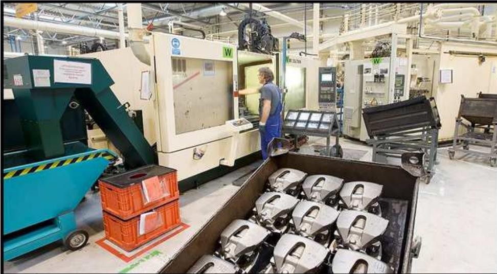
Na obrobni sú inštalované kovoobrábacie CNC stroje typov STAMA, SW, Honsberg, Hoffmann a meracie zariadenia ZEISS. Koovoobrábacie stroje sú zoskupené do jednotlivých výrobných línii, ktoré opracovávajú držiaky a púzdra (základné komponenty brzdového strmeňa). Väčšina strojov opracovávajú púzdra z liatiny, niektoré stroje opracovávajú púzdra z hliníka
